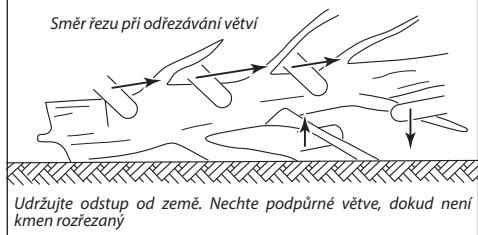
Tímto se rozumí oddělení větví od poraženého stromu. Při odřezávání větví ponechejte nejdříve větví, které strom podepírají. Menší větve, oddělé jedním řezem. Větve, kterou jsou napnuté, by měly být odřezávány odspodu nahoru, aby se zabránilo sevření pily.
