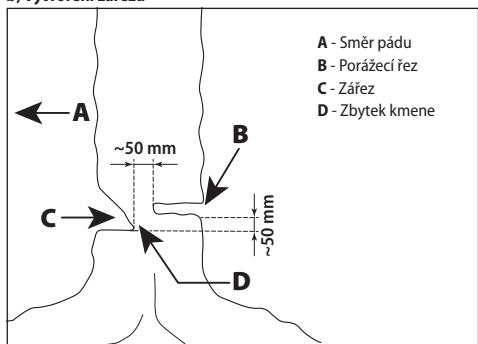
Vyřízněte v pravém úhlku ke směru pásu stromu zárez hloubky 1/3 průměru stromu. Nejprve provedte vodorovný řez. Tím se zabrání zaseknutí pily nebo vodicí listy při nasazení druhého řezu.
