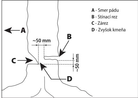
Vyrežte v pravom uhlе ku smeru pásu stromu zárez hlboký  $1/3$  priemeru stromu. Najprv urobte vodorovný rez. Tým sa zabráni zaseknutiu píly alebo vodiacej lišty pri nasadení druhého rezu.
