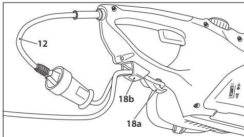
Táto reťazová píla je pre zabezpečenie prívodného kábla vybavená odhláčovaním tahu (18a). Zapojte najskôr zástrčku sietového kábla prístroja (12) do prívodného kabla. Vytvorte na pripojnom kabli slúchku a prestrečte ju mostikom (18b) na spodnej strane stroja. Slúchku zaveste do háku (18a). Pripojný kábel je teraz zabezpečený proti samovolnému vytiahnutiu.
