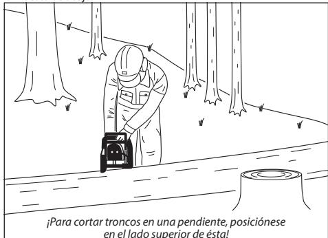
**¡Para cortar troncos en una pendiente, posiciónse en el lado superior de éstal!**
