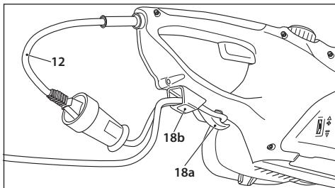
Niniejsza pilarka łańcuchowa posiada dla zabezpieczenia kabla zasilającego uchwyt antynapięciowy (18). Najpierw załączyć wtyczkę kabla zasilającego narzędzi (12) do kabla zasilającego. Na kablu wytworzyć pętle i włożyć ją od dołu do otworu dla kabla (18b). Pętlę zawiesić do uchwytu (18a). Kabel zasilający jest teraz zabezpieczony przed samowolnym wyciągnięciem.
