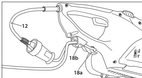
Esta motosierra está equipada con atenuador de tracción (18) para asegurar el cable de alimentación. Conecte primero el enchufe (12) del cable eléctrico del equipo (12) con el cable de alimentación. Haga un bucle en el cable de conexión y páselo por la guía para cable (18b), en la parte inferior del equipo. Enganche el bucle en el gancho de seguridad (18a). El cable de conexión queda asegurado contra su extracción no deseada.
