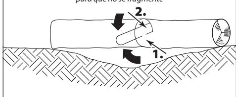
Si el tronco se apoya en sus extremos, sobre una hondonada del terreno, como se muestra en la imagen, corte primero 1/3 del diámetro del tronco por su parte inferior, y luego el resto desde arriba, a la altura de la muesca de abajo.
