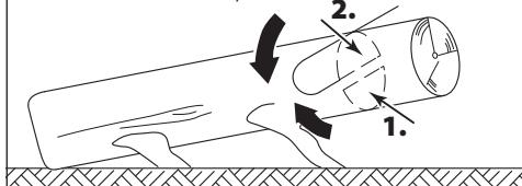
Если ствол лежит одной стороной на земле и противоположная сторона приподнята, как указано на рисунке, выполните сперва надрез до одной трети диаметра ствола с нижней стороны и потом остаток сверху на высоту нижнего надреза.
