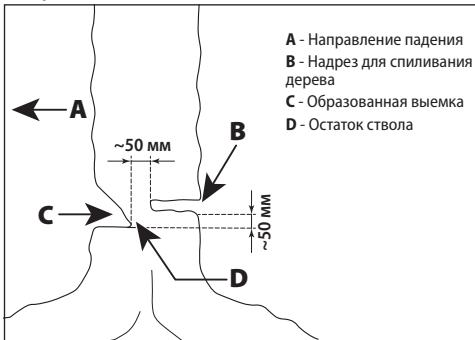
В прямом углу к направлению полосы дерева вырежьте выемку глубиной 1/3 диаметра дерева. Сперва выполните горизонтальный надрез, который предотвратит заедание пилы или планки в течение выполнения другого надреза.
