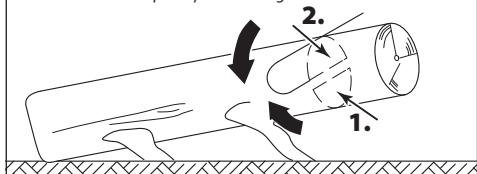
Si el tronco se apoya en un extremo, como se muestra en la imagen, primeramente haga una muesca de 1/3 del diámetro del tronco por abajo, luego el resto desde arriba, a la altura de la muesca inferior.
