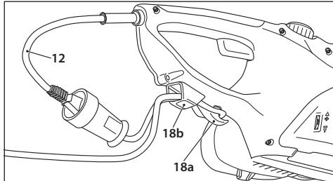
Tato řetězová pila je v zajištění přívodního kabelu vybavena odlehčováním tahu (18). Zapojte nejdříve zástrčku sítového kabelu přístroje (12) do přívodního kabelu. Vytvořte na připojném kabelu smyčku a prostřítě ji můstekem (18b) na spodní straně stroje. Smyčky zavěste do háku (18a). Připojný kabel je nyní zajištěn proti samovolnému vytážení.
