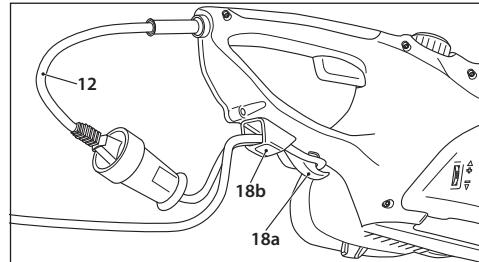
A gép a hálózati vezetéket rögzítő (húzás ellen is védő) kábelakaszival (18) van ellátva. Első lépésként csatlakoztassa a gép hálózati vezetékét (12) a hosszabbító aljzathoz. A hosszabbító vezetéken képezen húrkot és bújtassa át a kábelhídon (18b) a fogantyú alján. A húrkot a kihúzás be a kampóba (18a). A hosszabbító kábel így biztosítva lesz a kihúzás ellen.
