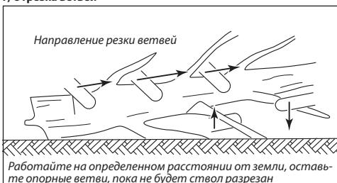
Работайте на определенном расстоянии от земли, оставьте опорные ветви, пока не будет ствол разрезан
