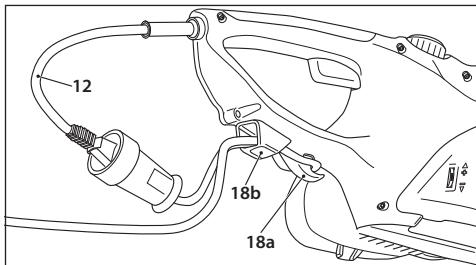
Для защиты подводящего кабеля эта цепная пила оснащена разгрузкой натяжения (18). Сперва соедините штекер сетевого кабеля прибора (12) с подводящим кабелем. На присоединительном кабеле образуется петлю и проденьте ее через мостик (18b) на нижней стороне прибора. Петлю подвесьте на крюк (18a). Таким способом присоединительный кабель защищен от самопроизвольного разединения.
