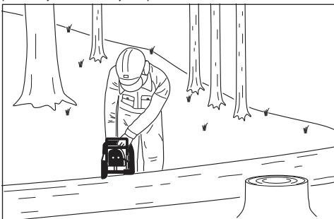
Pri rezaní vo svahu vždy stojte nad kmeňom smerom do svahu, ako znázorňuje obrázok. Aby ste v momente „prerezania“ mali plnú kontrolu, znižte na konci rezu prítlak, bez toho aby ste uvoľnili pevné zovretie držadla píly. **Pozor, aby sa reťaz nedotykovala zeme!** Po ukončení rezu počkajte na zastavenie reťaze, pred tým než pílu vytiahnete.
