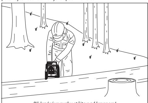
*Při řezání ve svahu stojte nad kmenem směrem do svahu, jak znázorňuje obrázek. Abyste v momentě „proříznutí“ měli plnou kontrolu, snížte u konce řezu přítlač, aniž uvolníte pevně sevření držadel pily. Pozor, aby se řetěz nedotýkal země!*
