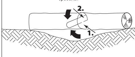
Если ствол лежит над впадиной, подпротян на концах, как указано на рисунке, выполните сперва надрез до одной трети диаметра ствола с нижней стороны и потом остаток сверху на высоту нижнего надреза.
